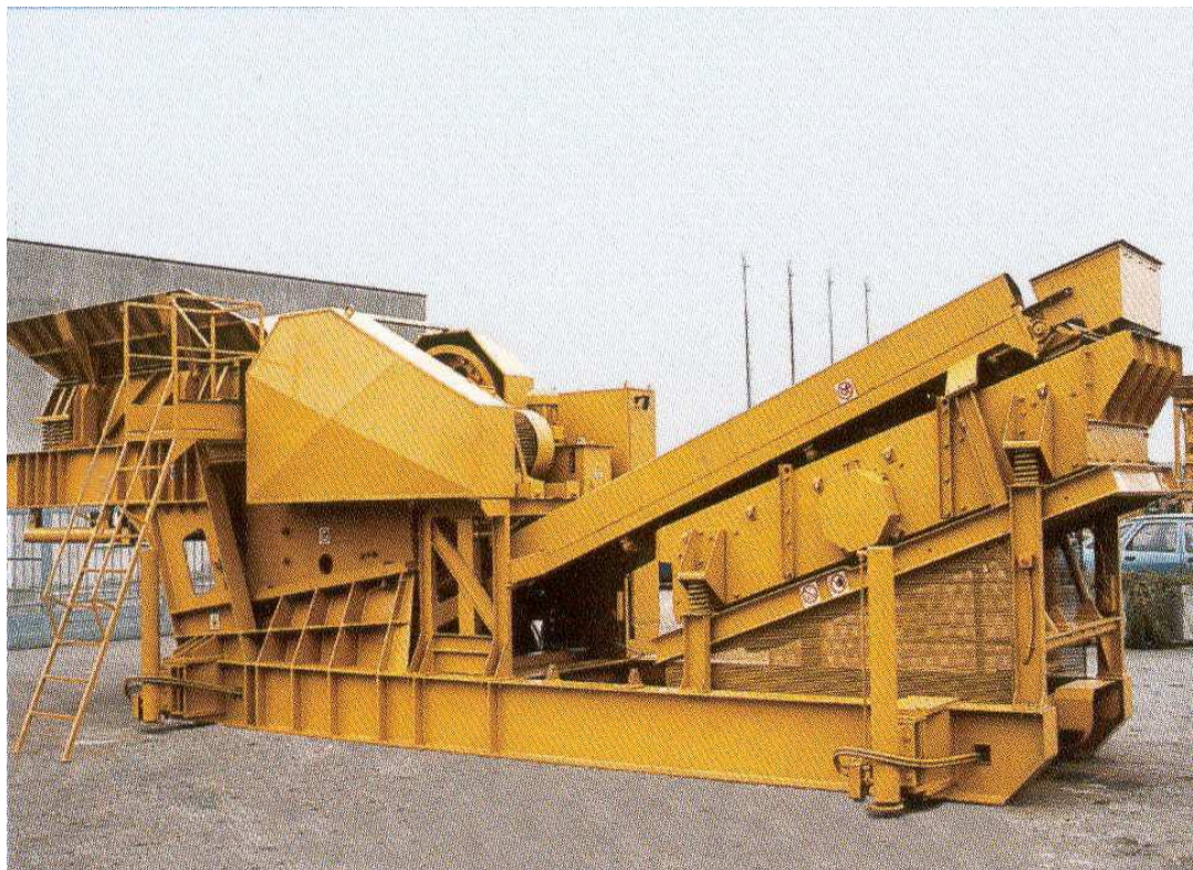
Fig. 16 – Impianto di frantumazione primaria e vagliatura (0-100 T/h)
